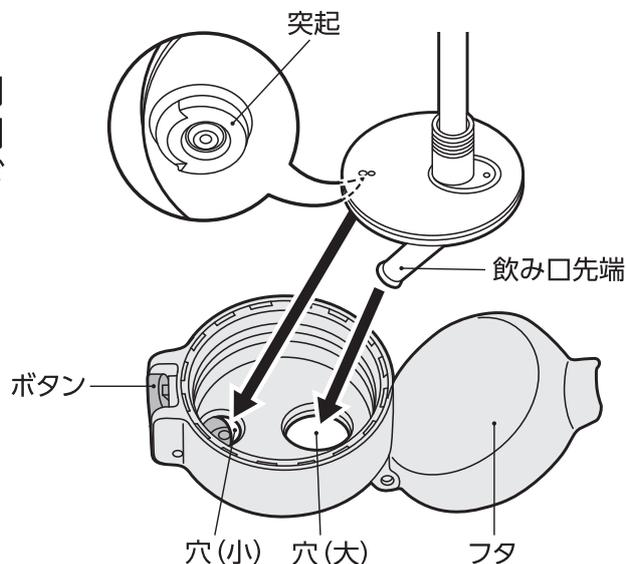
②ストロー取り付け部の左右を押し込みます。その後、ボタン側の突起を穴(小)に押し込みます。
